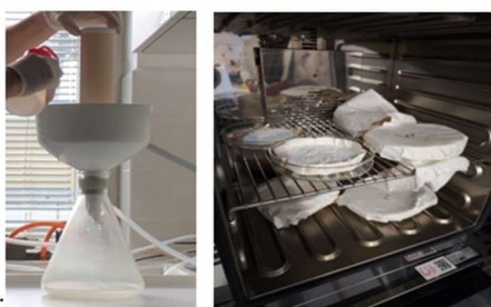
Obrázok 6. Filtrácia sušenie pripravených sférických častíc (a) zariadenie na vákuovú filtráciu na zber mikroguličiek, (b) sušenie vzoriek v sušiarňi.
