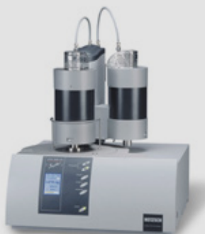
Netsch STA 449 F1 Jupiter TG/ DTA/DSC simultánny analyzátor Netsch STA 449 F1 Jupiter TG/ DTA/DSC simultaneous analyser
