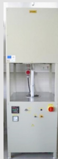
Vysokoteplotná elevátorová pec-I Elevator furnace - I
